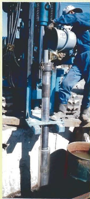
透明管による井戸仕上げ模擬テストの様子
