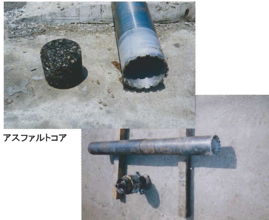
φ140コアチューブ 接続サブ(ウォータースィーベル)
