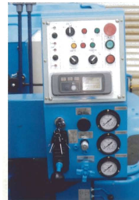
メイン操作盤(掘削用)
