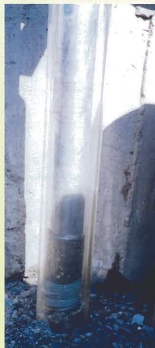
透明管による井戸仕上げ模擬テストの様子
